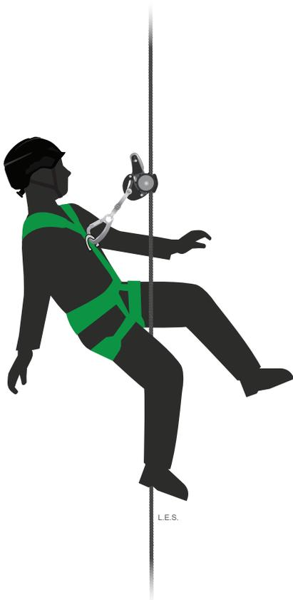
O trava-queda deslizante é um equipamento capaz de reter a queda de um trabalhador. Ele funciona em linhas de segurança verticais, deslizando por uma guia, seja ela constituída por uma corda, por um cabo de aço ou por um trilho. Ele é conectado ao cinturão de segurança e acompanha os movimentos do trabalhador de subida e descida. Caso a queda ocorra ele trava sobre a guia e detém a queda sem a necessidade de qualquer ação do trabalhador.
