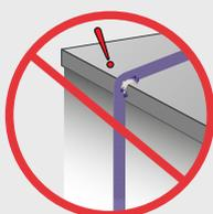
Nunca permita que uma corda tenha contato com uma superfície abrasiva (muito áspera), um canto vivo ou qualquer superfície com arestas que possam partir as suas fibras. Uma corda sob tensão é muito vulnerável a danos nessas condições e no momento da retenção de uma queda a corda pode se partir facilmente.
