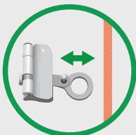
Certifique-se da compatibilidade do equipamento com a corda. Itens como marca, modelo e diâmetro devem ser observados. No caso do trava-queda deslizante o manual do produto deve indicar o modelo, a marca e o fabricante da corda ou das cordas com os quais o dispositivo pode ser usado.
